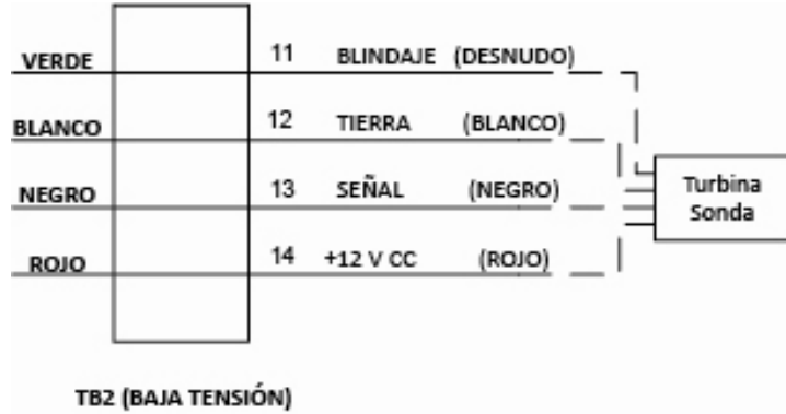
Figura 3 - Conexiones del sensor de flujo Autotrol
